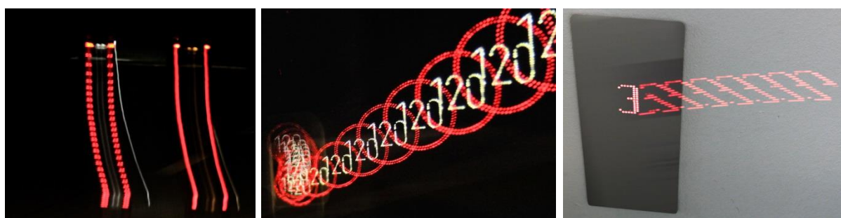
Abb. 1: Beispiele für Flicker in Rückleuchten (links), Wechselverkehrszeichen (Mitte) und Anzeigen, hier eines Fahrstuhls (rechts)
