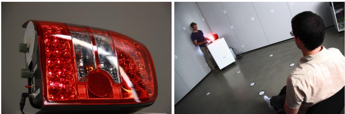
Abb. 4: Versuchsträger (links, Leuchtelemente sind die 12 LEDs auf der linken Seite, Frequenz- und Tastverhältnis über Bedienfeld links) und Versuchsaufbau (rechts - Versuchsträger mit Versuchsleiter links oben, Proband rechts unten)
