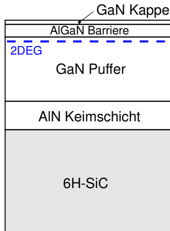
Bild 7: Aufbau der mittels MBE gewachsenen GaN/AlGaN/GaN Heterostruktur.
