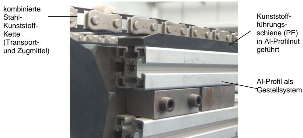
Bild 1: Tribologisches System Gestell-Führungselement in herkömmlicher Bauweise
