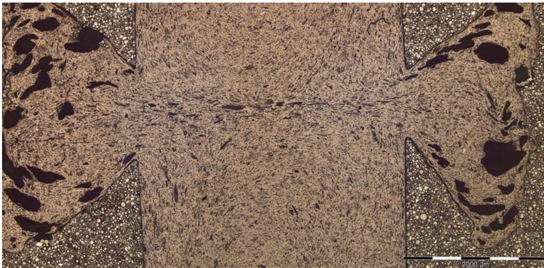
Bild 5: WPC 50% PP, 50% Holz ( T_{HE} 240°C, p_F 0,1 N/mm 2 ), Auflichtmikroskopie einer Schliffprobe 2,5 fach
