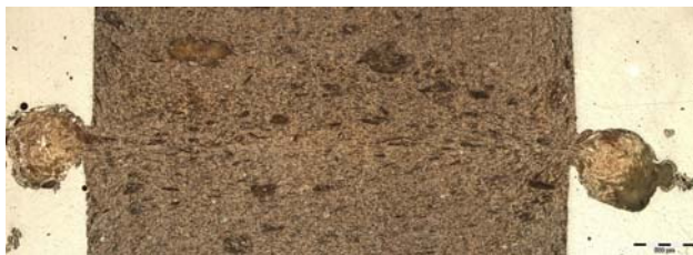
PP mit Haftvermittler und 50% Holz
