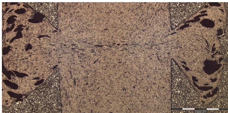
Bild 3: WPC 50% PP, 50% Holz ( T_{HE} 240°C, p_F 0,1 N/mm²), Auflichtmikroskopie einer Schliifprobe 2,5 fach
