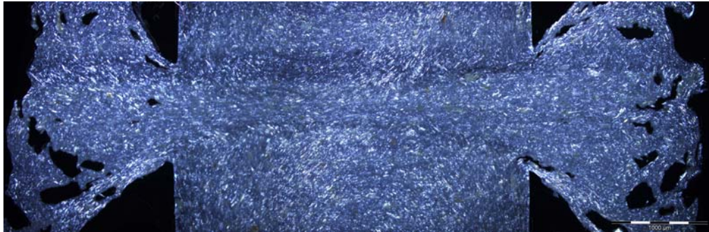
Bild 4: WPC 50% PP, 50% Holz ( T_{HE} 240°C, p_F 0,1 N/mm 2 ) Durchlichtmikroskopie einer Dünnschnittprobe, 2,5 fach
