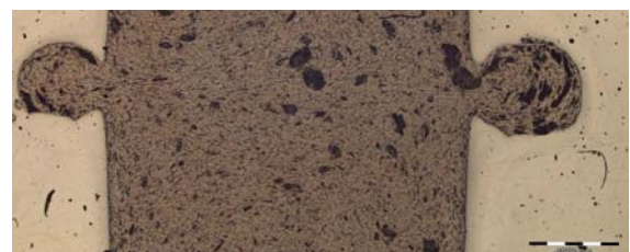
PP mit Haftvermittler und 30% Holz
