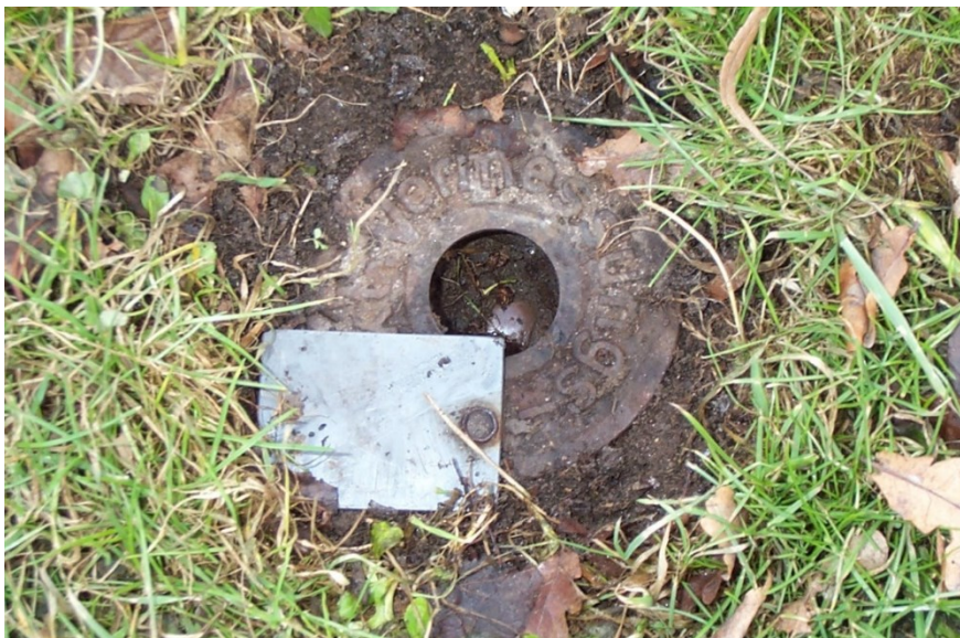
Abb. 1: Sichtbarer Teil der Vermarkung der Messpunkte
